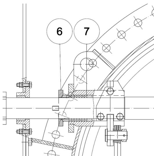
7. Retirar completamente el prensaestopas (6) y extraer la empaquetadura (7) con la ayuda de un destornillador y/o un extractor de empaquetaduras (asegurarse que no queda nada en el interior de la caja).
